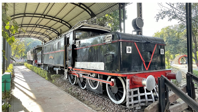
WCG/1 (sir Leslie Wilson) komt uit een serie van 41 machines en is in 1928 gebouwd door het Britse Metropolitan Vickers. 1500 V gelijkspanning
