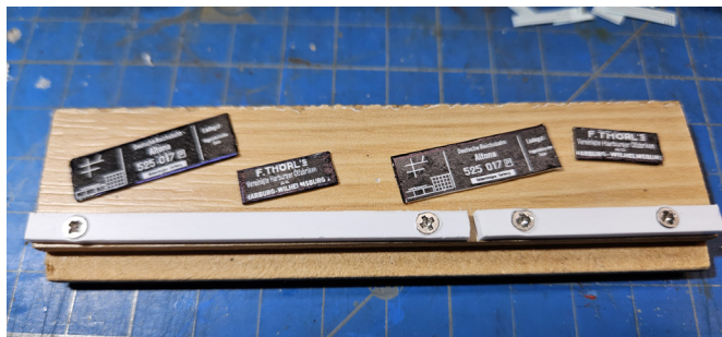
18. De identificatieborden worden uit Evergreenplaat gesneden, en beplakt met de decals. Dat ziet er al professioneel uit nietwaar? Ondertussen ook nog even een nieuw snijplankje gemaakt.
