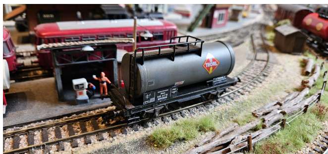
20. De identificatieborden worden vastgezet met een klein druppeltje 10 secondelijm, en het bordes krijgt nog een looprooster van nylon verpakingslint.
