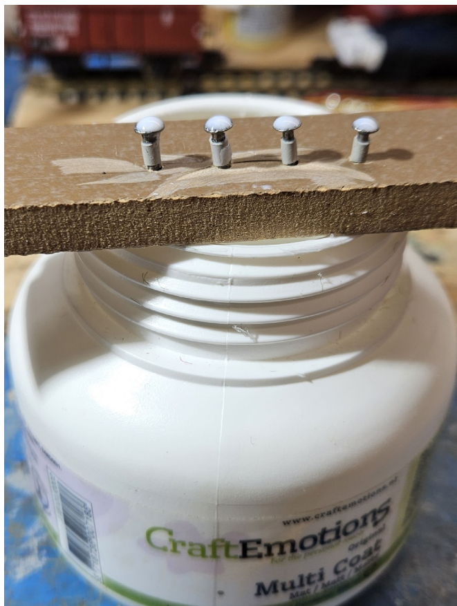
8. De decoupagelijm (of Modpodge) wordt gebruikt als vulmiddel voor de bovenkant van de buffers. Na droging kun je er eentje vlakschuren, en de andere een beetje bol laten.
