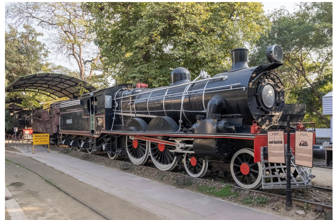
Deze in 1907 door North British Locomotive Works gebouwde EM-922 heeft asindeling 4-4-2. Hij reed aanvankelijk voor de Great Indian Peninsula Railway, later voor de North Western Railway.
