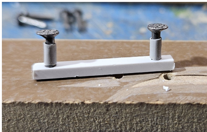
7. Hier een proefopstelling van de nieuwe buffers op de nieuwe bufferbalk.
