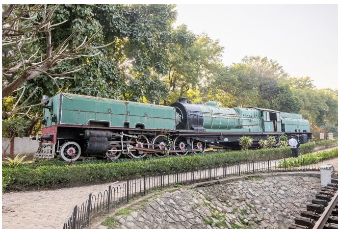
Uit een serie van 16 locs werd deze 4-8-0+0-8-4 Garratt machine in 1930 gebouwd voor de Bengal Nagpur Railway (BNR)
