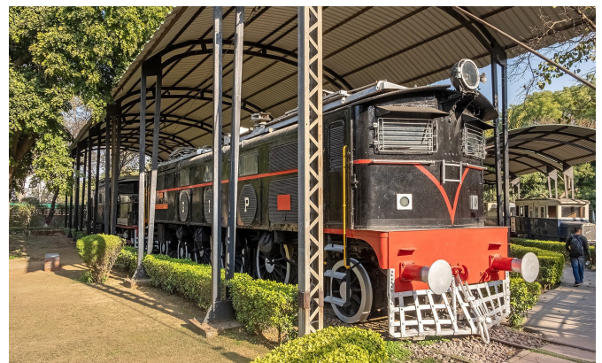
WCP/1 (sir Roger Lumley) werd in 1930 gebouwd voor de eerste sneltreinen tussen Bombay en Poona. 1500 V gelijkspanning.
