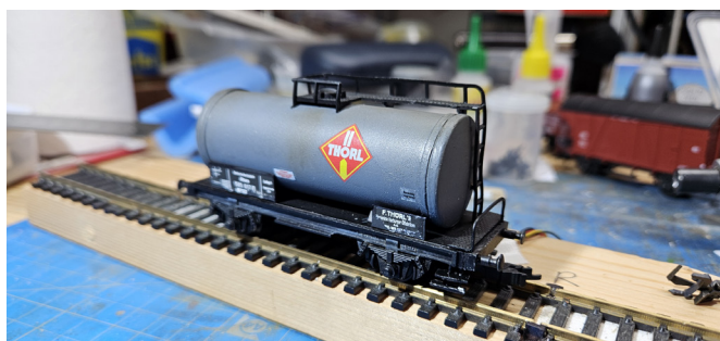
20. De identificatieborden worden vastgezet met een klein druppeltje 10 secondelijm, en het bordes krijgt nog een looprooster van nylon verpakingslint.
